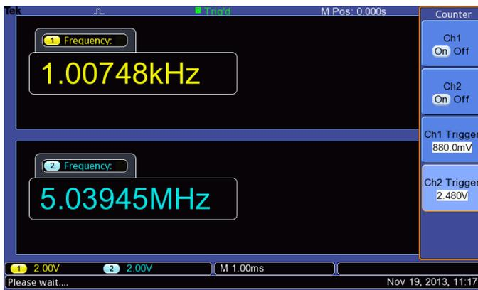
Двухканальный 6-разрядный частотомер входит в перечень базовых функций всех моделей осциллографов серии TBS1000B.
