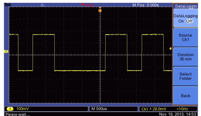
Функция регистрации данных позволяет автоматически сохранять захваченные сигналы.
