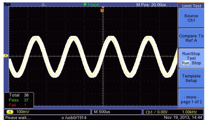
Функция контроля предельных значений обеспечивает быструю разборокку «годен/не годен», сравнивая входные сигналы с заданными пользователем шаблонами.
